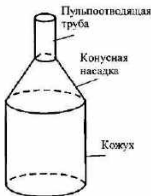
Рис. 1.55. Конусная насадка с цилиндрическим кожухом для пульпоотводящей трубы эрлифта
