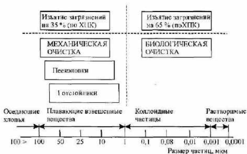
Рис. 2.6. Последовательное изъятие органических частиц (в зависимости от их размера) на разных ступенях очистки сточных вод
