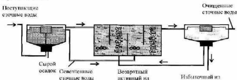
Рис. 2.39. Процесс нитрификации-денитрификации, обеспечиваемый сочетанием аэробных и анаэробных процессов в разных коридорах аэротенка
