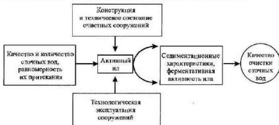
Рис. 3.46. Основные факторы и параметры процесса очистки сточных вод, воздействующие на биохимические и седиментационные характеристики активного ила
