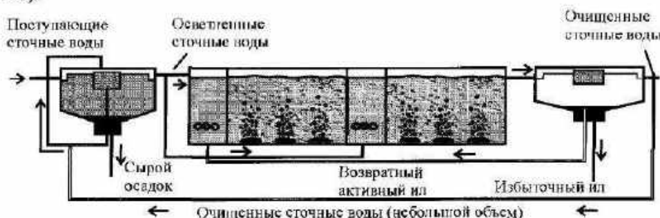
Рис. 2.52. Схема использования первичного отстойника для ацидофикации сырого осадка
