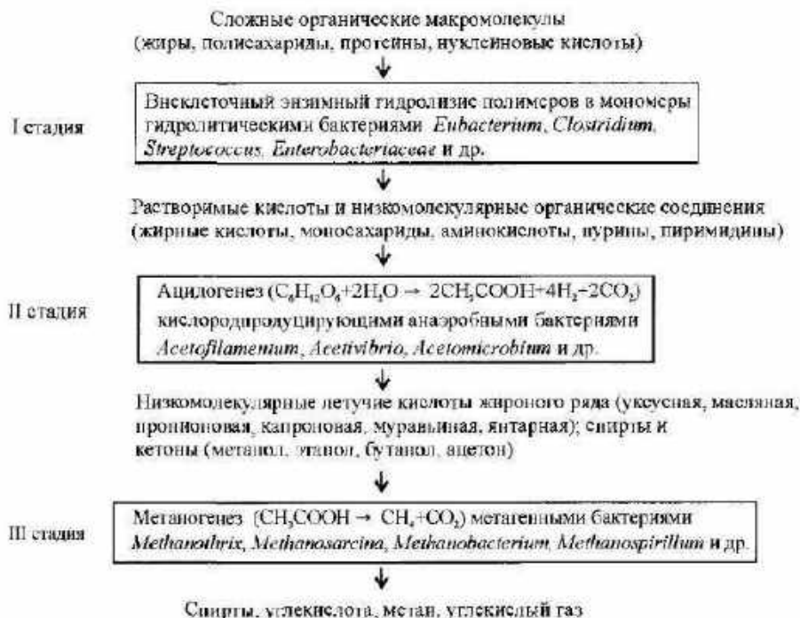
Рис. 2.51. Трехстадийный процесс анаэробного разложения органических соединений
