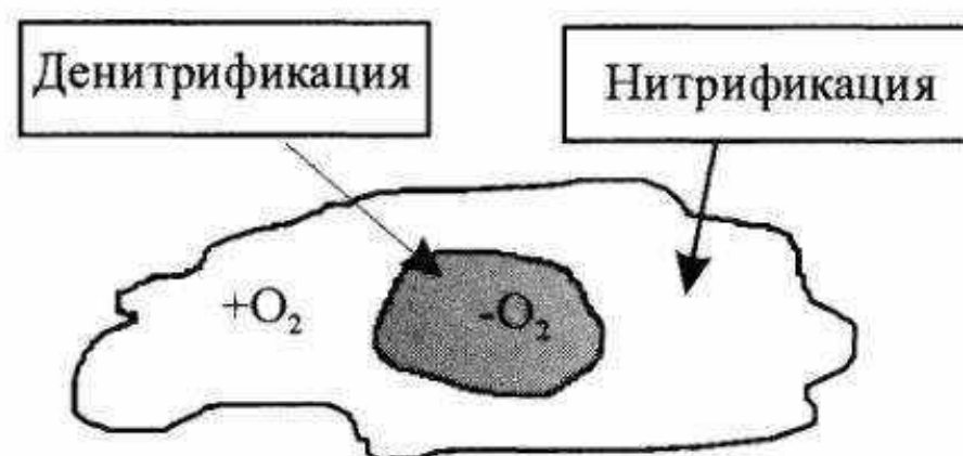
Рис. 2.29. Нитрификация-денитрификация в разных участках хлопка активного ила
