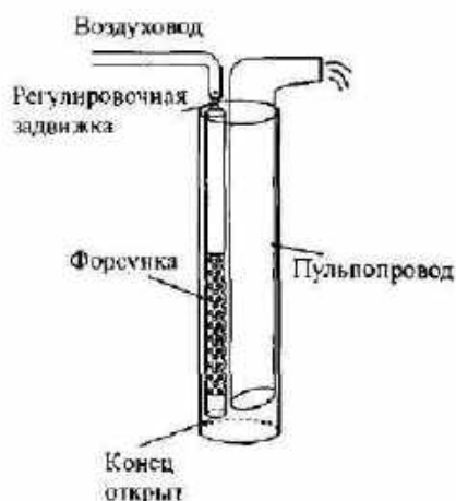
Рис. 1.53а. Эрлифтная форсунка, расположенная рядом с пульпоподъемной трубой
